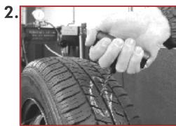
2. Infle o pneu um pouco acima do normal. Detecte a inclinação de perfuração com auxílio da agulha especial e faça movimentos rotativos, para acomodar as pontas das lonas e facilitar a aplicação do Ruziseal.
