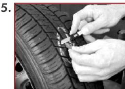
5. Retire a agulha e corte o excesso de Ruziseal, 1 mm acima da banda de rodagem.
