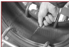
Remova o objeto que danificou o pneu e limpe a área afetada tomando cuidado para não aumentar o dano e não afetar a estrutura do pneu.
