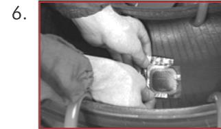
Retire o filme protetor da ligação (metallizado), evitando qualquer contato com a mesma. Aplique o reparo centralizando-o no dano.
